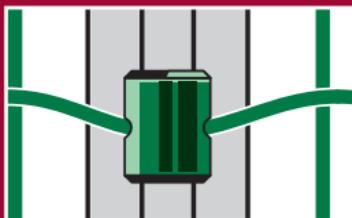
2. Grâce aux qualités techniques des clôtures soudées, vous pouvez facilement tendre 25 m en une seule opération. Ne jamais mettre le grillage sous tension à hauteur d'un poteau intermédiaire, c'est à dire un poteau qui n'est pas aidé par les jambes de force.
