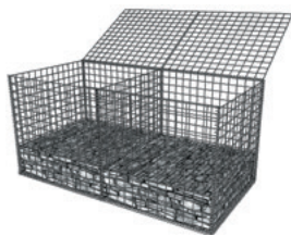
6 Remplir le gabion
